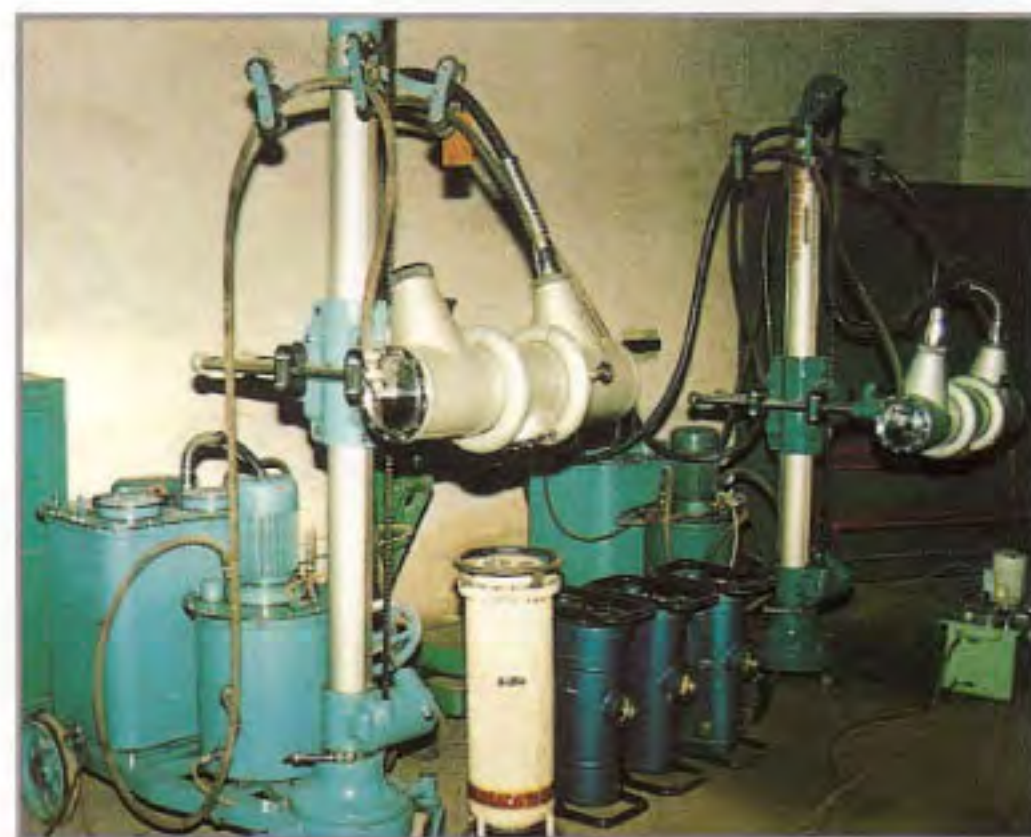
周向X光机 (荷兰 飞利浦) X-ray machine
