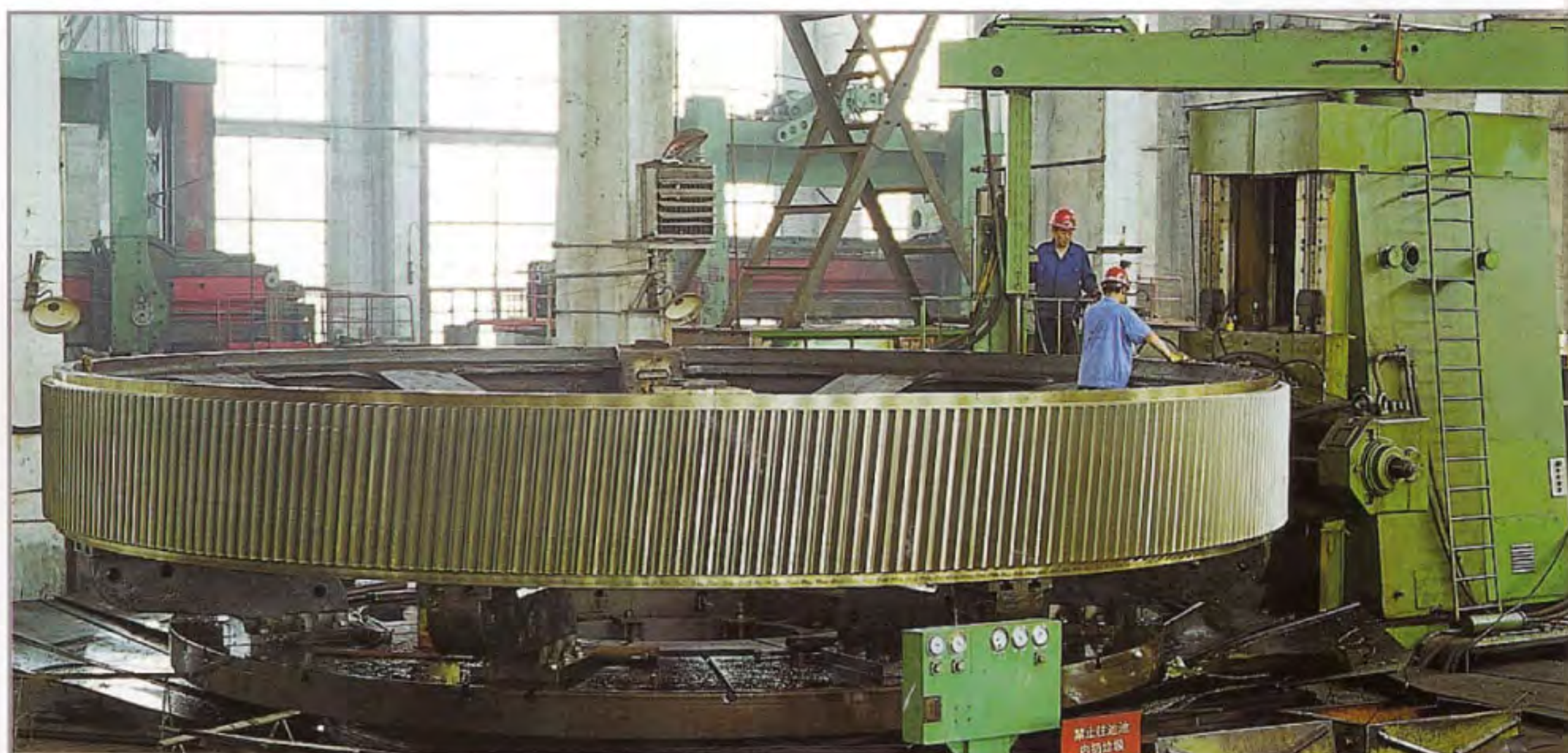
Φ10m 滚齿机 Φ10m hobbing machine
